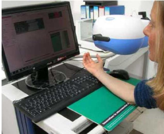
**Test nel laboratorio di Tessile e Salute con un laser doppler utilizzato per la valutazione della perfusione superficiale (microcircolo)**
